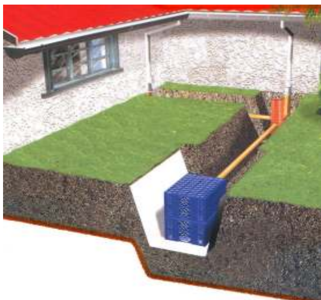
Widok na podstawowy segment indywidualnej neutralizacji deszczówki
