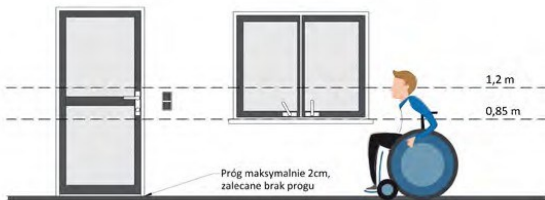
Ilustracja 63. Przykład okna i drzwi balkonowych dostosowanych do potrzeb osób poruszających się na wózkach, rys. Agnieszka Sowińska i Maria Görlich-Opyd (opracowanie własne na podstawie „Standardów dostępności architektonicznej dla m.st. Warszawy”)
